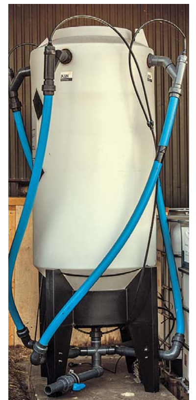
Beholder til at lave kompost-te i, en Vortex Compost Brewer, som bruges hos Almende.
