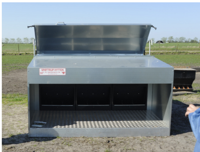
Prototype på foderautomat til ungsvin på friland.
