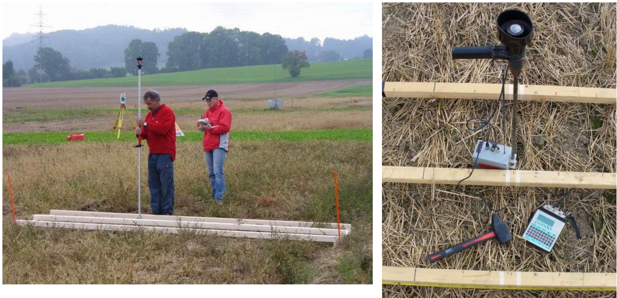
Figur. 5. Til venstre: Måling af jordoverfladeprofilen. Til højre: Penetrometer til bestemmelse af penetrationsmodstanden i jorden.
