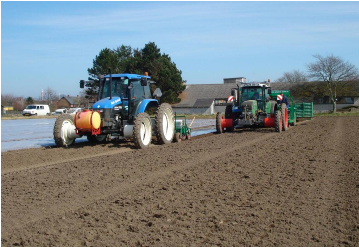
Figur. 4. CTF i grøntsagsdyrkingen. Traktorsporene er lige så brede som bedene. (Foto: Hans Henrik Pedersen)
