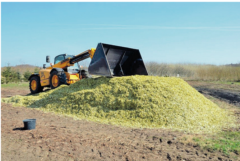
Opbygning og formning af stakken med løbende udjævning og komprimering af pileflisen. Foto: Søren Ugilt Larsen, Teknologisk Institut.
