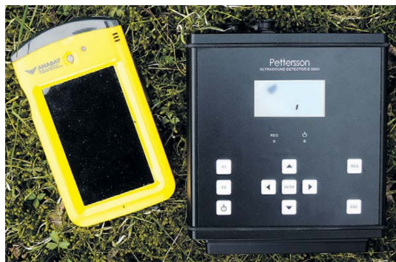
Udstyr til at optage flagermus. Optageren til venstre er håndholdt mens loggeren til højre kan spændes fast til træer natten over.
