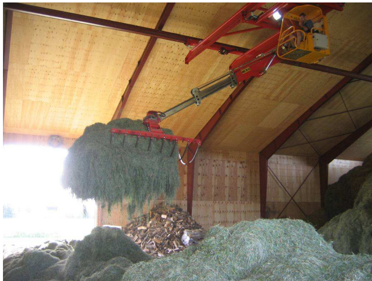
Figur 9. Høet lægges ind på tørregulvet med løbekran.
