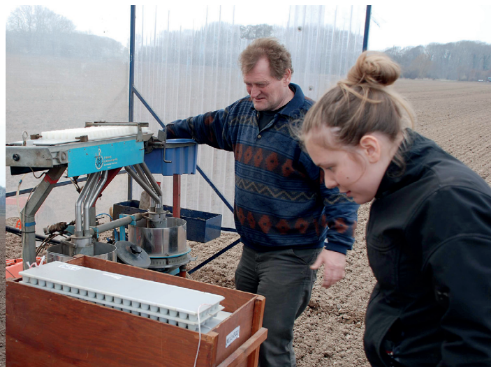
Såning af forsøgspareller d. 16. april med specialudstyr fra Nordic Seed, der kan håndtere såning af små mængder udsæd. I nærværende afprøvning var der ca. 10 g til rådighed af hver af de 400 forædlingslinjer. FOTO: HELGE KJÆR SØRENSEN
