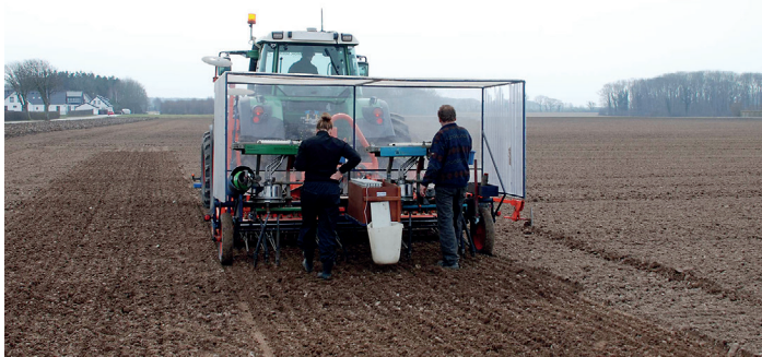
Såning af forsøgspareller d. 16. april med specialudstyr fra Nordic Seed, der kan håndtere såning af små mængder udsæd. I nærværende afprøvning var der ca. 10 g til rådighed af hver af de 400 forædlingslinjer. FOTO: HELGE KJÆR SØRENSEN
