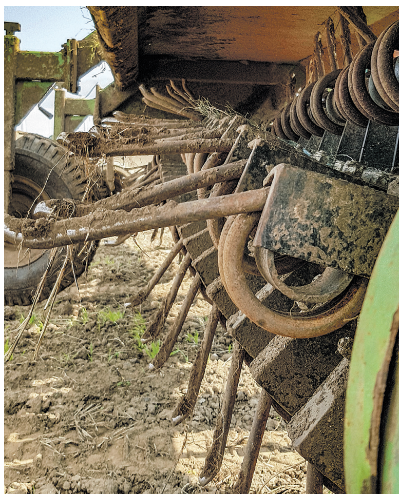
Den hurtigt roterende fingrefterharve kaster blandt andet kvik-rødder op på jordoverfladen, hvor de kan udtørre.
