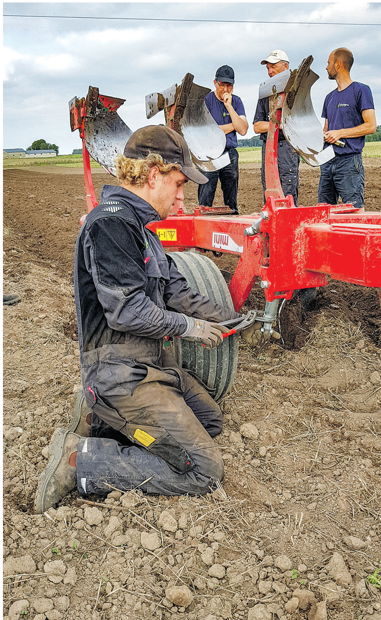
Pløjedybden på den spanske Ovlac-plov kan meget hurtigt indstilles.
