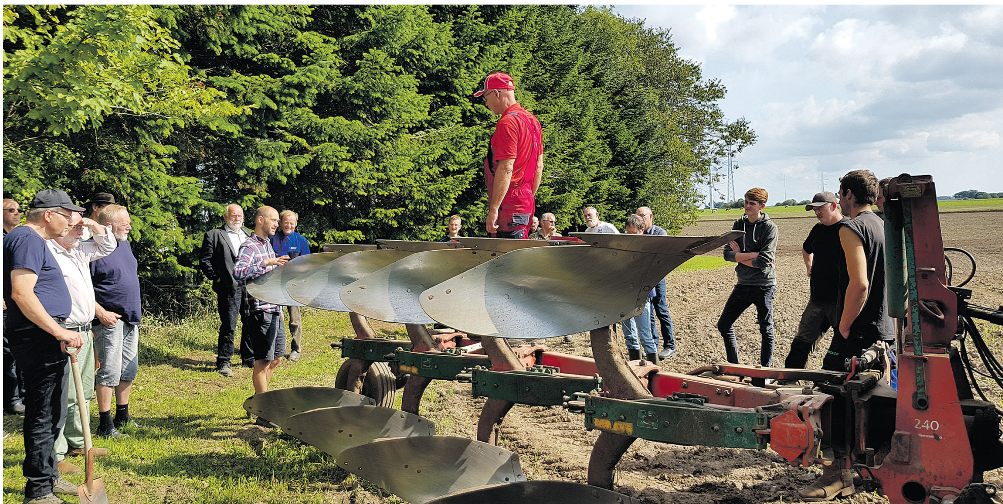
Tage Fisker (på ploven) demonstrerede sin skrælplov for blandt andre Jonas Høeg fra ØRD, der sørgede for at supplere den praktiske erfaring med teoretisk viden.
