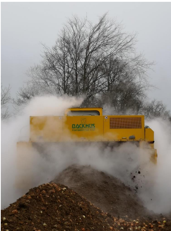
Figur 6 De store miler bliver i begyndelsen vendt med kompostvender dagligt. Vendingerne bliver sjældnere som ugerne skrider frem. Foto: Månsson
