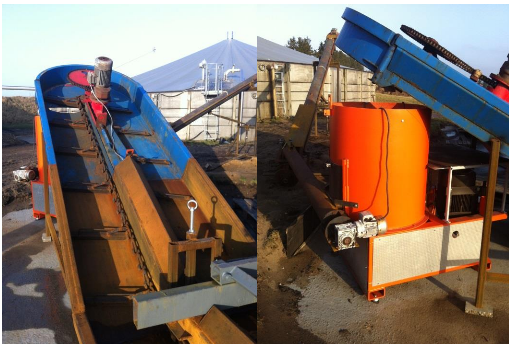
Fig 2. Transportbånd, kædeknuser og indsnebling der kan håndtere Bjarne Viller Hansens grønne biomasser
