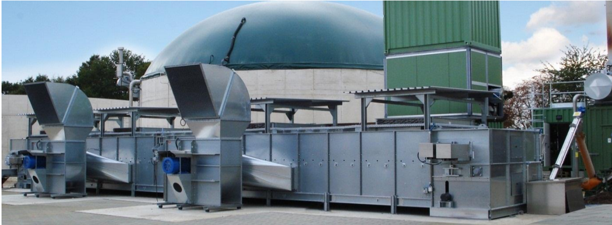
Figur 25: Bæltetørrer til ferment-tørring foran et biogasanlæg (Kilde: STELA Laxhuber GmbH)
