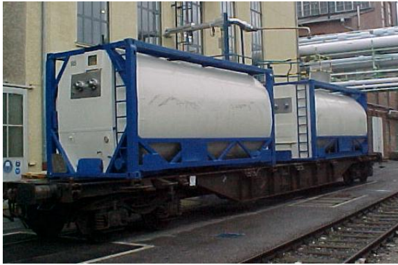
Figur 22: Togvogn med et latentvarmelagringsystem (Kilde: TransHeat GmbH)
