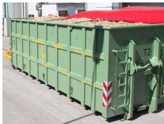
Figur 28: Container til tørring af træflis i München, Tyskland (Kilde: Rutz)
