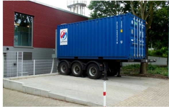
Figur 23: Trailer med en container og et latent varmelagringsystem (Kilde: LaTherm GmbH)
