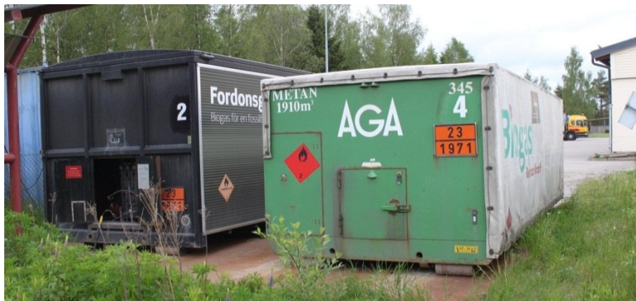
Figur 43: Containere til transport af CBG fra biogasanlægget i Borås, Sverige (Kilde: Rutz)
