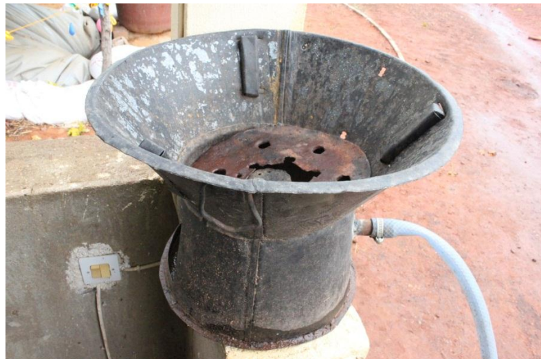
Figur 2: En af de simpleste anvendelser af biogas: Biogas komfur til madlavning i Mali (Kilde: Rutz)
