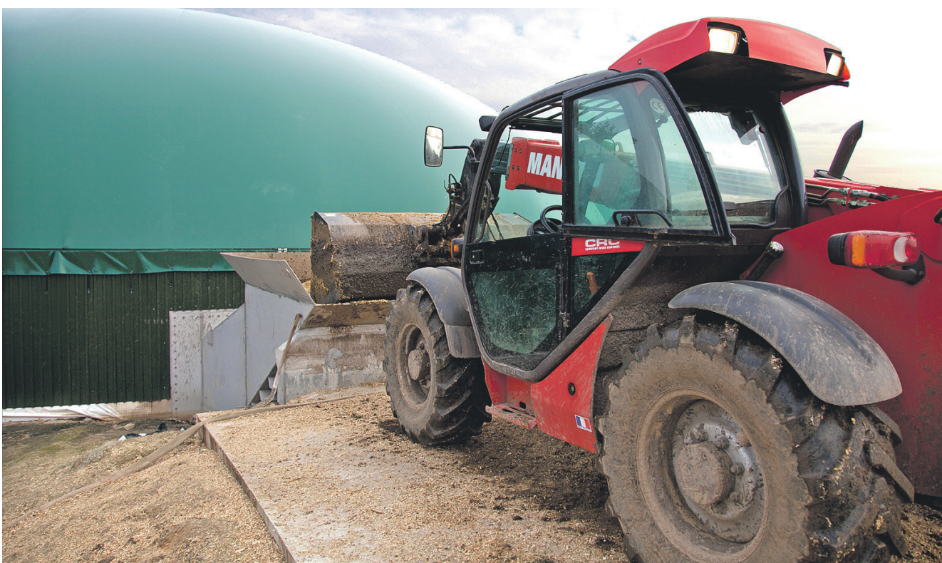
Sauter-anlægget er enkelt opbygget. Indføringen sker direkte uden forbehandling med frontlæsser.
