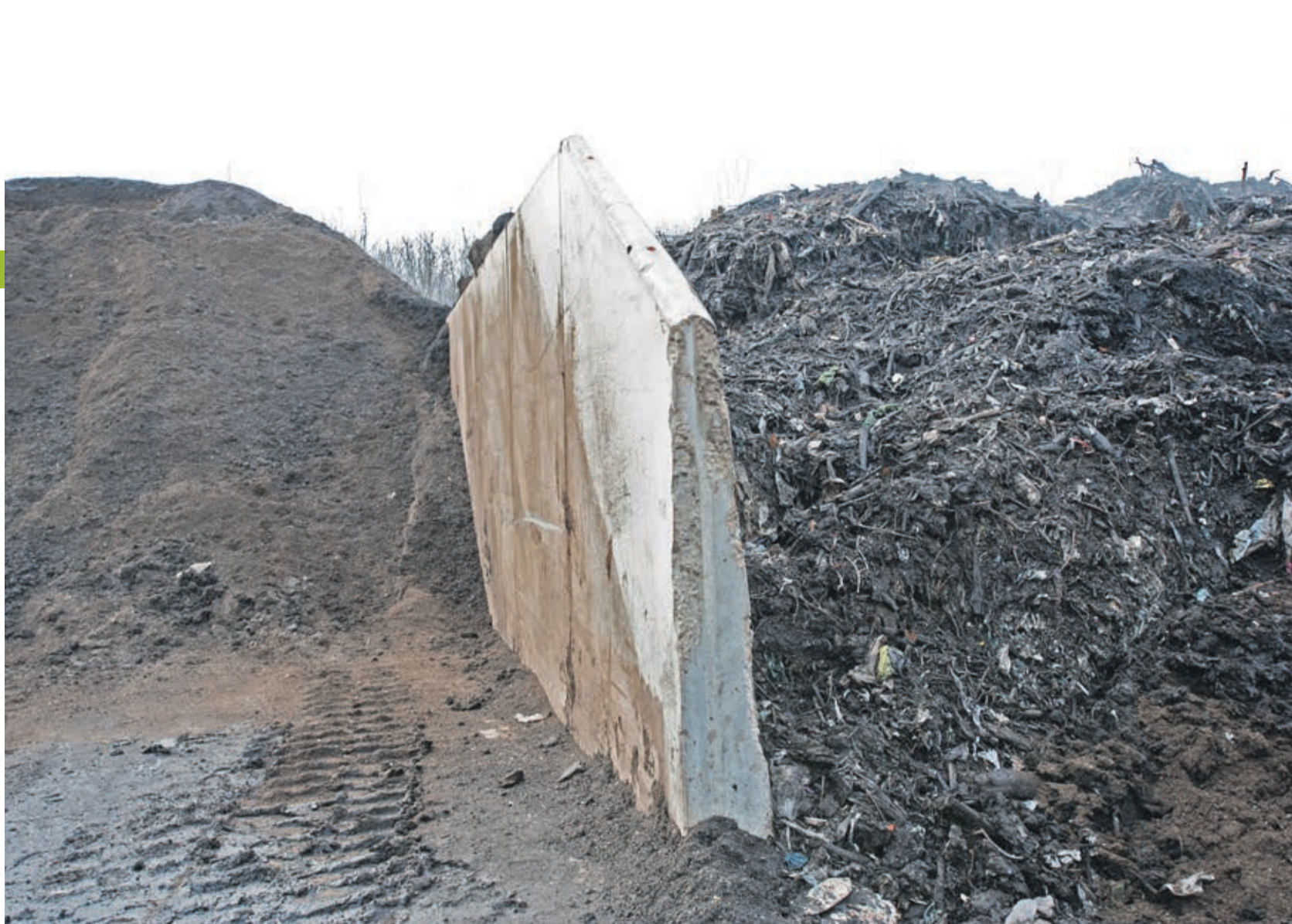
Th: afgasset husholdningsaffald, tv. færdig kompost. Først når materialet er afgasset, bliver plastik, glas og metal sorteret fra.
