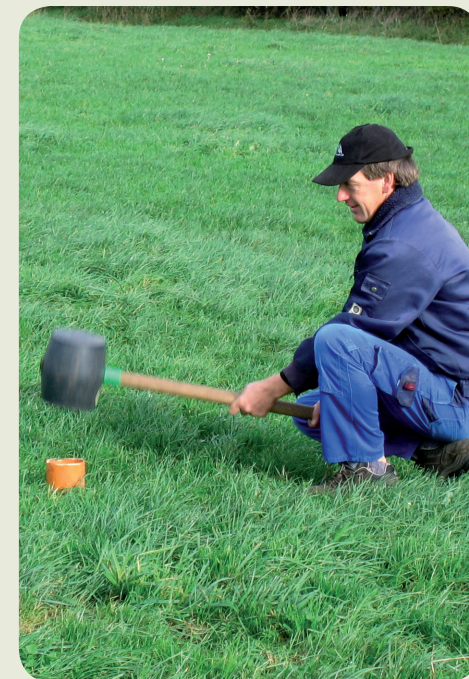
20-25 PVC-rør bankes ned i jorden og fyldes med en saltvandsopløsning
