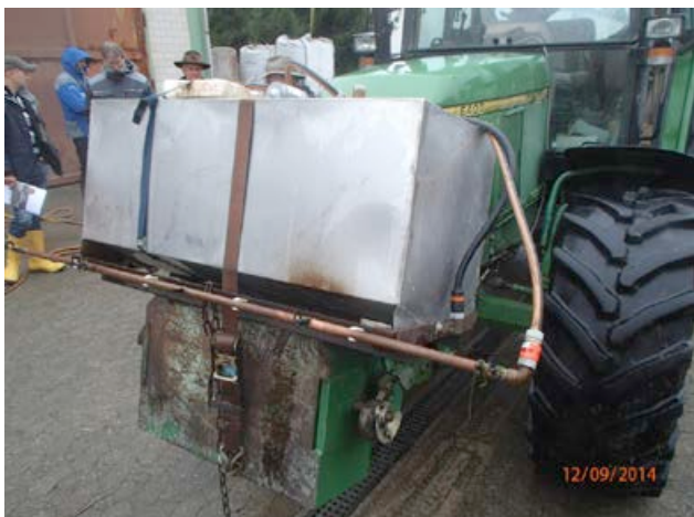
Fronttank med elektrisk pumpe som sprøjtebom (Foto: Friedrich Wenz)
