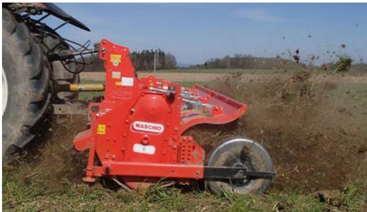
Skrælfresning i 3-4 cm dybde. (Foto Dietmar Näser)
