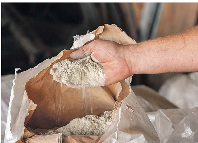
Betonit er fint formalede ler, der kan suge store mængder vand på grund af indholdet af kolloider. Foto: Anna-Christa Bjerg
