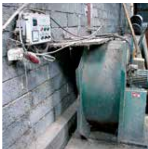
Kornet bliver hurtigst muligt nedtørret med det mindst mulige energiforbrug med en hygrostat. Foto Gunnar Smith.
